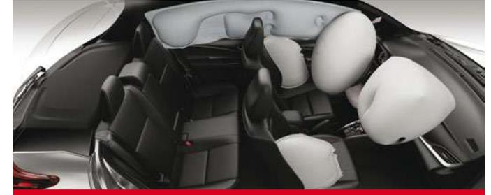
Airbags frontales (conductor y acompañante), laterales (x2), de cortina (x2) y de rodilla (para conductor).<sup>(1)</sup>
