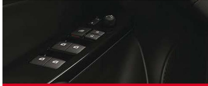
Levanta cristales eléctricos con función "One Touch" en las cuatro puertas.<sup>(1)</sup>
