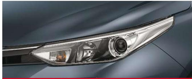
Ópticas delanteras halógenas con regulación en altura y proyector.<sup>(1)</sup>
