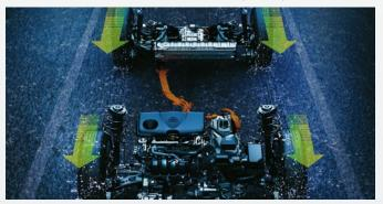
Se trata de un nuevo sistema de tracción electrónica inteligente denominado "e-Four" que proporciona torque en las 4 ruedas según la situación lo demande. Este sistema fue desarrollado para brindar una conducción propia de un SUV y una excelente eficiencia en combustible.
