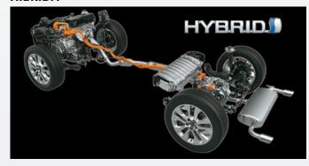
El nuevo sistema híbrido auto-recargable de Toyota RAV4 está compuesto por **dos motores** (naftero + eléctrico) que trabajan conjuntamente, otorgando una potencia total de **222 CV**.
