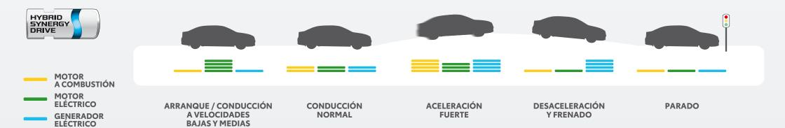
A diferencia de los vehículos convencionales que funcionan gracias a un motor de combustión interna, un auto híbrido es impulsado por la energía que le proveen sus dos motores, uno naftero y otro eléctrico.
